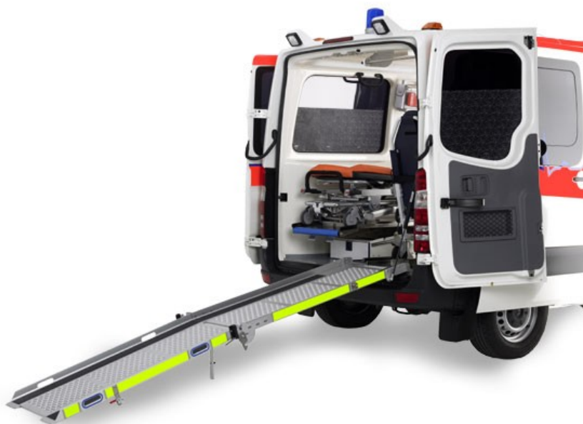
Abbildung 2: Ansicht der Beladerampe (Ausklappvorgang)
