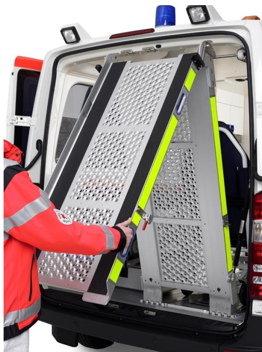
Abbildung 2: Ansicht der Beladerampe (Ausklappvorgang)
